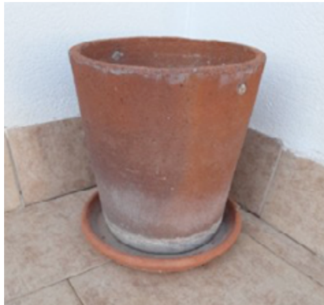
Figura 4. Crisol de cerámica refractaria usado en los hornos de fundición de metal de los talleres ferroviarios de la Compañía del Ferrocarril Central de Aragón (propiedad de la familia Carbó-Belau).
