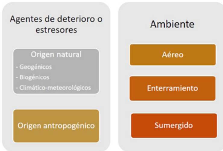
Figura 15.3. Clasificación de causas de deterioro atendiendo a su origen y al medioambiente.
