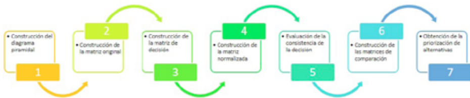
Figura 17.4. Diagrama de flujo algoritmo AHP.
