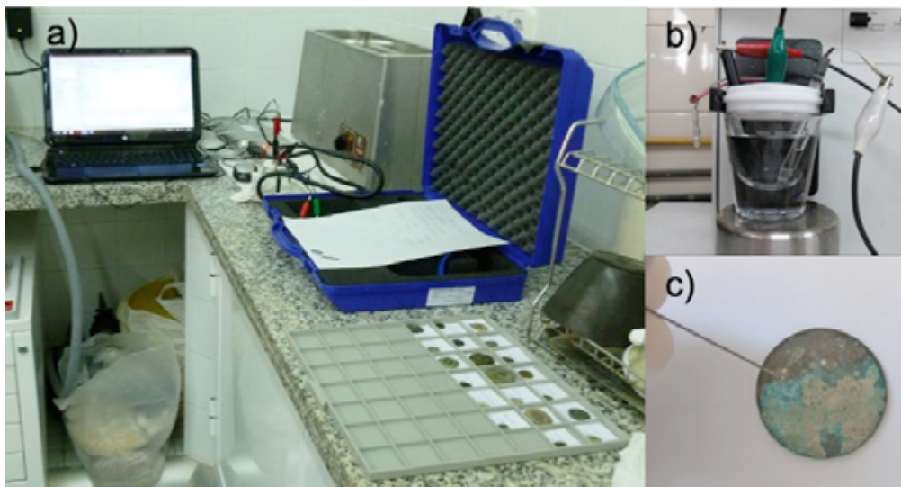
Figura 3.4. a) Analizador voltamperométrico portátil; b) detalle de la celda electroquímica; c) detalle del electrodo de grafito de diámetro 0,5 mm.
