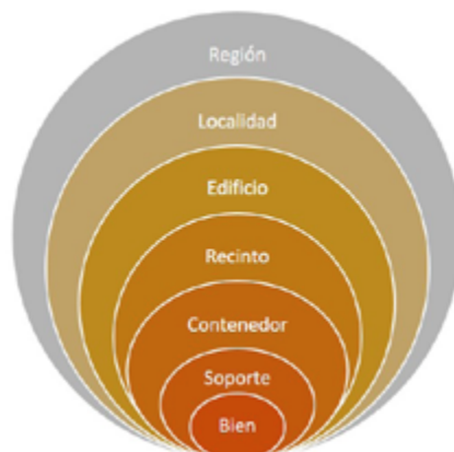
Figura 15.2. Esquema de las diferentes envolventes del bien cultural.
