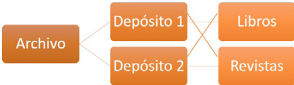
Figura 3.11. Esquema de base de datos en red.
