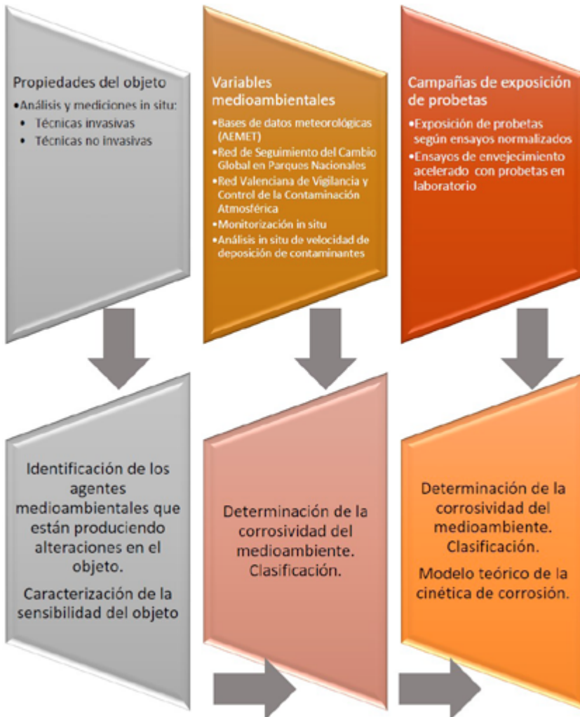
Figura 6.10. Esquema mostrando la estructura básica de un programa de monitorización.
