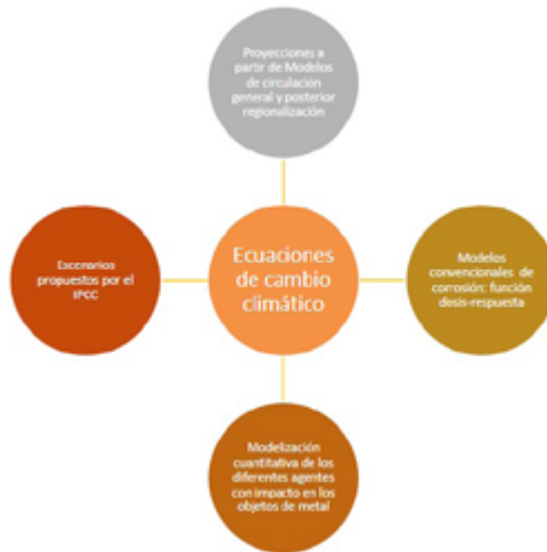
Figura 7.10. Marco metodológico utilizado para desarrollar modelos de corrosión adaptados a los efectos del cambio climático.
