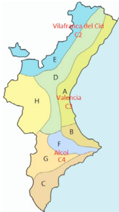
Figura 8.1. Distribución de puntos de obtención de datos para el estudio de la tendencia estacional del clima de la Comunitat Valenciana. Junto a la población se indica la categoría de corrosividad según la norma UNE-EN ISO 9223:2012 que a priori se atribuye a cada población y por la cual se han seleccionado estas tres localidades.
