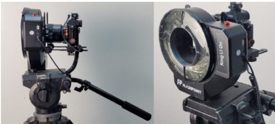
Figura 12.2. Cámara fotográfica digital y flash de luz polarizada.
