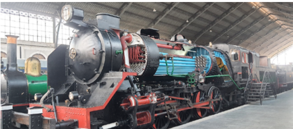
Figura 2.22. Locomotora Mikado 141 F -2416 preservada en el Museo del Ferrocarril de Madrid y seccionada con un propósito didáctico.
