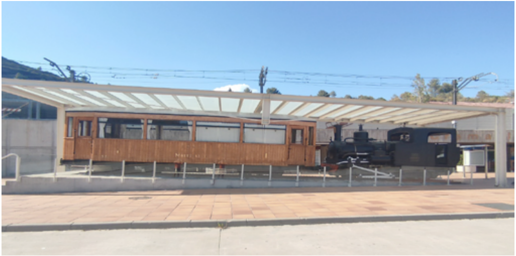
Figura 2.19. Locomotora de vapor de cremallera Monistrol preservada junto a un coche de pasajeros y protegida mediante una estructura de cubrición. En la vía se recrea una pendiente de unas 55 milésimas (5,5 %).
