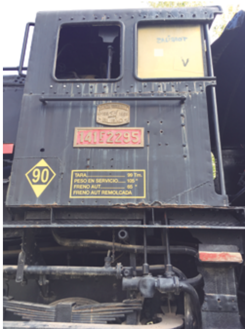
Figura 1.6. Desgaste de la pintura de acabado exterior.
