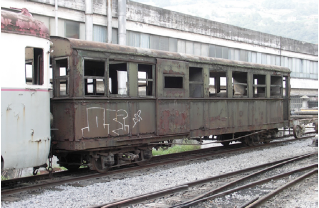
Figura 12.25. Aspecto que ofrecía el coche C-5 antes de iniciar su restauración, con la carrocería metálica construida en los años sesenta, totalmente afectada por la corrosión. Fotografía de Juanjo Olaizola Elordi.
