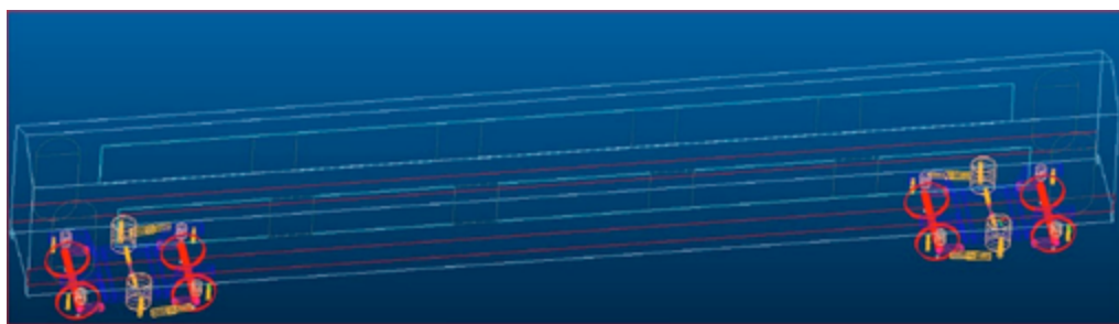
Figura 13.4. Modelo en VI-Rail de un vehículo ferroviario convencional.
