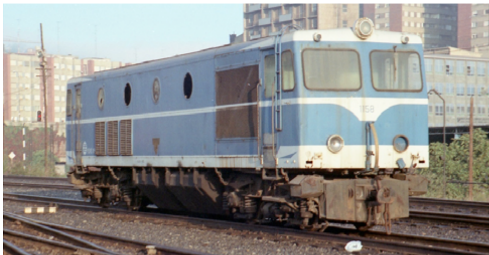
Figura 12.2. El primer vehículo preservado por el Museo Vasco del Ferrocarril fue la locomotora 1158 de Feve, construida por La Naval de Sestao, bajo licencia Creusot-Schneider, en 1958. Mayo de 1989. Fotografía de Juanjo Olaizola Elordi.
