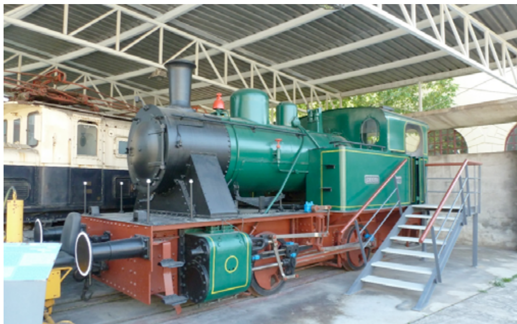
Figura 12.15. Locomotora de vapor «Echeverría», de vía ancha, restauración no operativa. Para su pleno funcionamiento requeriría la reparación de la caldera y la revisión de todos sus elementos. Fotografía de Juanjo Olaizola Elordi.
