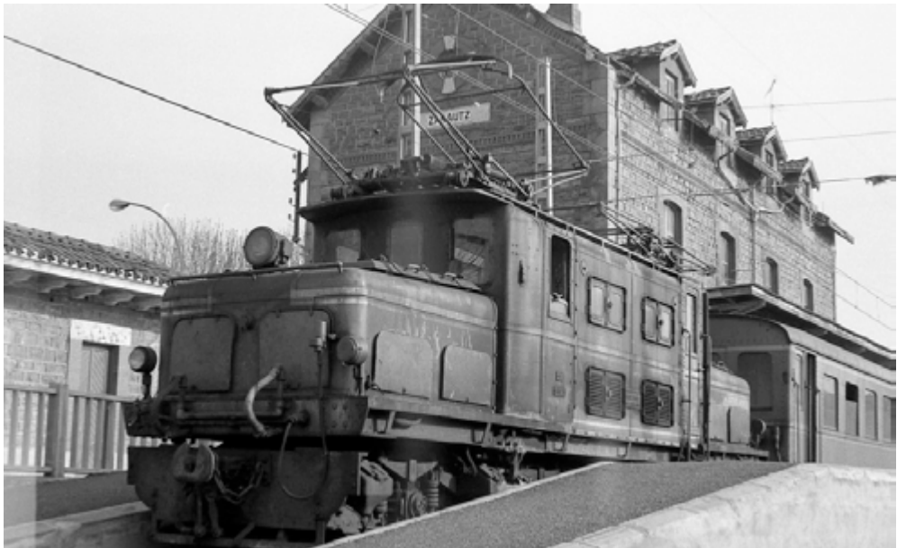
Figura 12.1. Locomotora eléctrica construida por la firma suiza Brown Boveri en 1928, fotografiada en servicio en 1982. Ante la falta de inversiones para su relevo, todavía se mantuvo activa en la red ferroviaria vasca durante una década más. Fotografía de Juanjo Olaizola Elordi.
