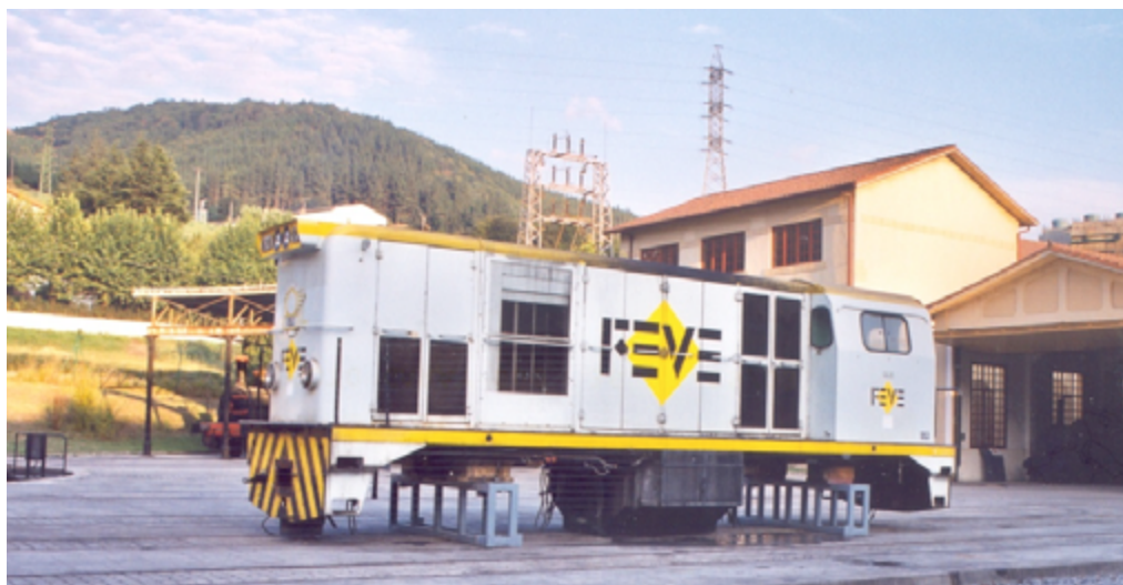
Figura 12.30. En el momento de su preservación, la locomotora Alsthom carecía de órganos fundamentales como los bogies, ejes, motores de tracción y aparatos de choque y tracción, entre otros. Fotografía de Juanjo Olaizola Elordi.
