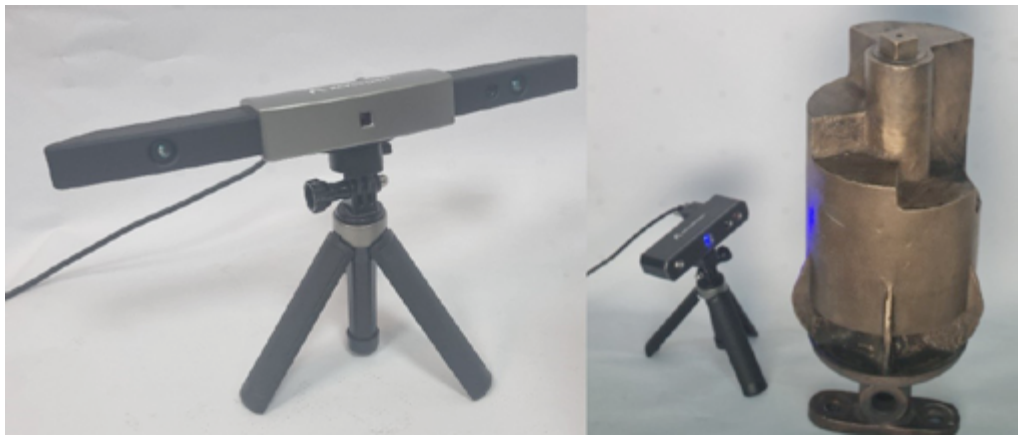
Figura 12.3. Escáner de luz estructurada. Escaneo del silbato.
