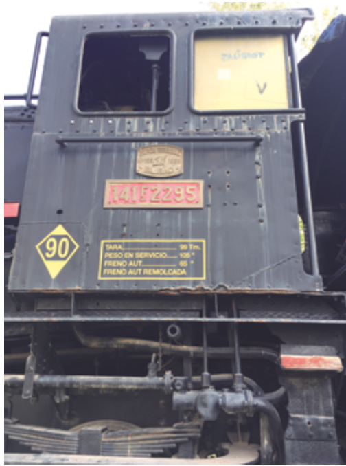
Figura 1.6. Desgaste de la pintura de acabado exterior.
