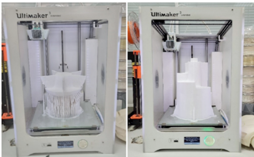
Figura 12.11. Impresión 3D del silbato (izquierda: parte inferior, derecha: parte superior).
