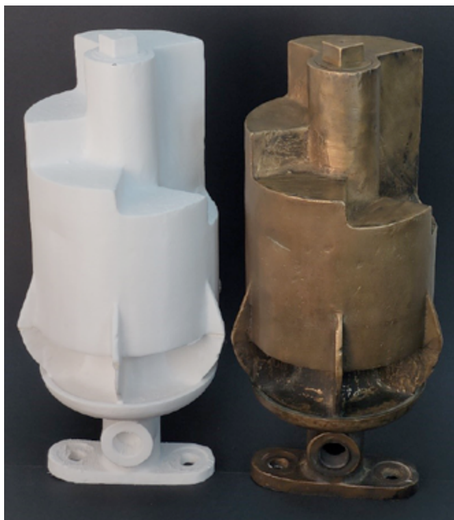
Figura 12.12. Réplica física del silbato junto con la pieza original.
